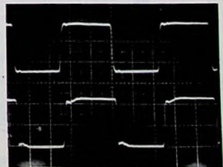
pulsen mit dem Oszilloskop unbedingt berücksichtigt werden. Ein 20-MHz-Oszilloskop beispielsweise hat eine Anstiegszeit von
